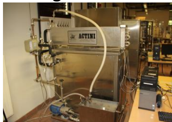
Echangeur de chaleur
